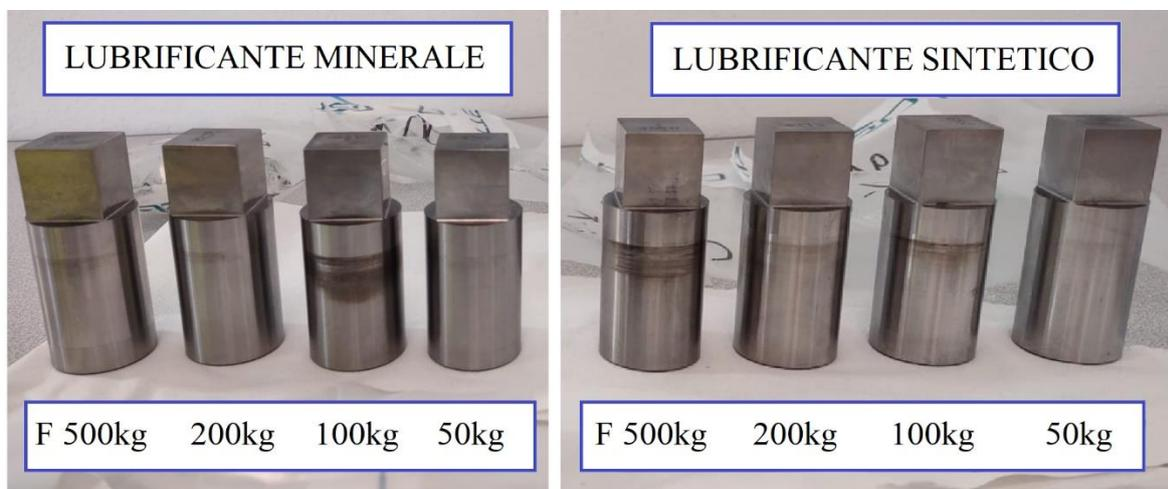
**Figura 65** - Foto dei perni dopo il test dove a sinistra quelli del lubrificante minerale e a destra quelli del lubrificante sintetico
