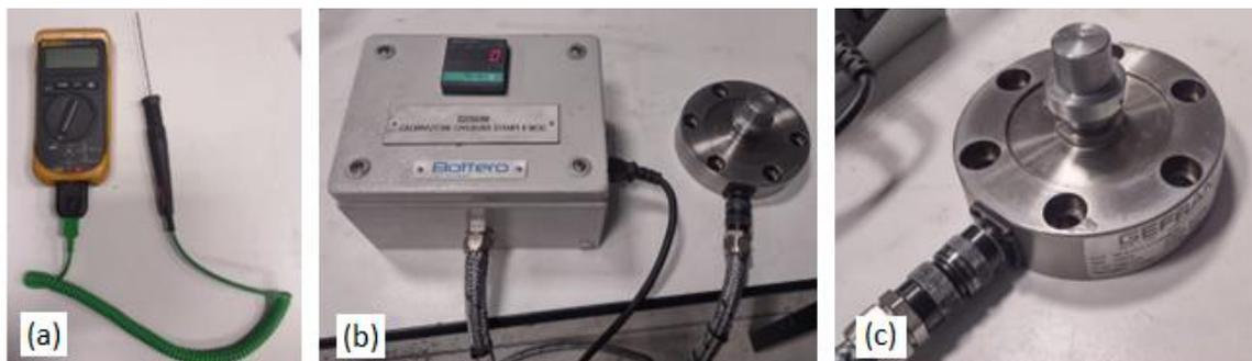
**Figura 47** - Foto del sensore di temperature (a), della cella di carico al completo con sistema di acquisizione (b) e dettaglio della cella (c),
