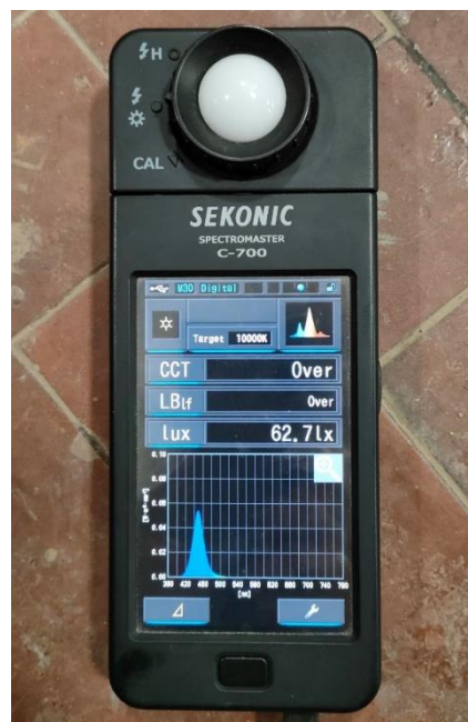
Figura 2.9: Spettrometro modello Sekonic C-700
