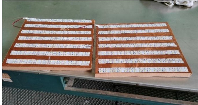
Figura 2.6: Strisce led montate sui pannelli
