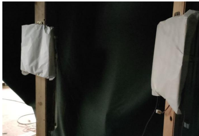
Figura 2.7: Carta velina posizionata sui pannelli per rendere la diffusione luminosa più omogenea
