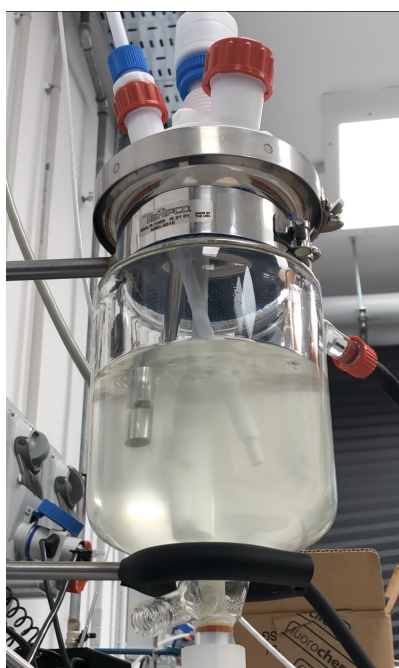
Figura 3.1: Reattore Radleys da 1L con sonda di temperatura (bianca) e sonda ASD12-N Optek
