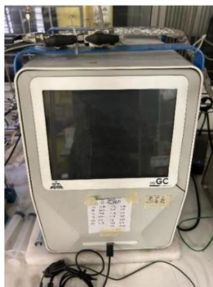
Figura 6.3 – Rappresentazione del gas cromatografo
