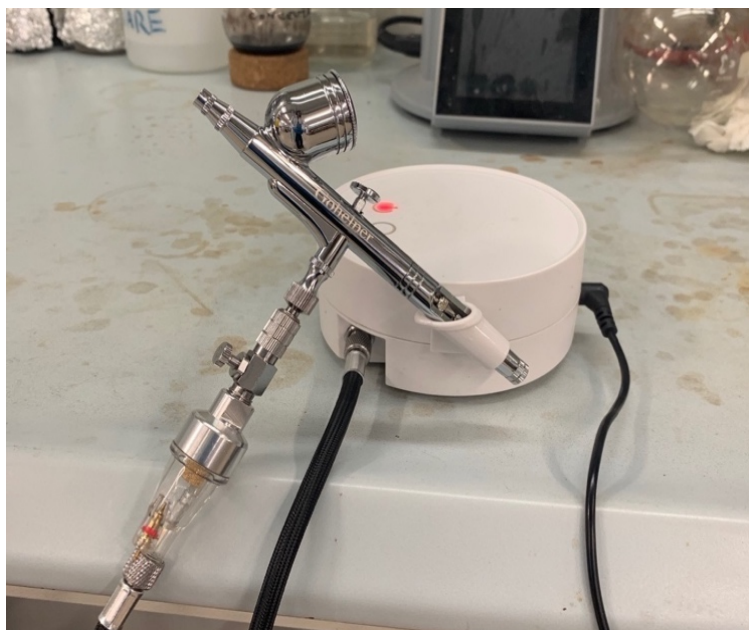
Figura 5.6: Mini compressore dotato di aerografo della Gohelper montato e acceso.
