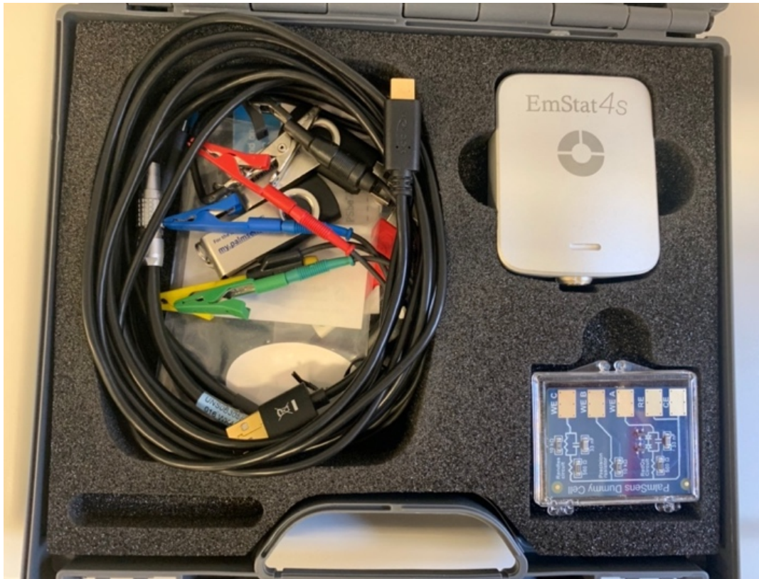
Figura 5.10: Potenziostato/galvanostato portatile EmStat4s della PalmSens per la Spettroscopia di Impedenza Electrochimica (EIS).
