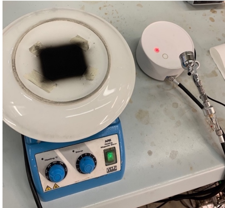
Figura 5.5: Deposizione dell'ink su carbon paper fissato su un piatto in ceramica posizionato su una piastra.
