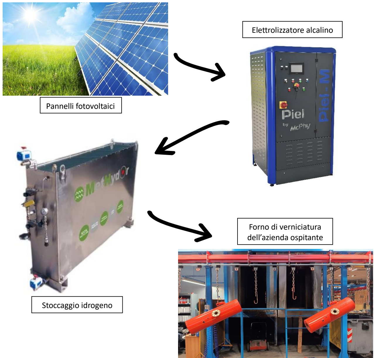
Figura 23. Schema semplificato dell'impianto del caso di studio [76],[77]
