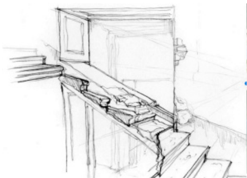
Figura 6 Reggia di Venaria Reale, scala detta "del Piacenza", 1788-89, stato precedente ai restauri. Particolare del passaggio di una cavità nel muro di sostegno, con barre metalliche sopra e sotto i gradini (da Burgassi, Novelli, Spila, p. 125).
