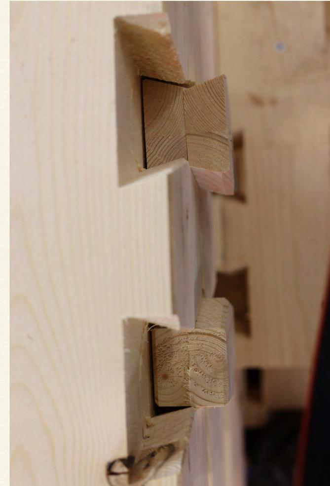
*Confronto produzione biscotti con lato a coda di rondine prodotti manualmente con sega circolare vs biscotti prodotti industrialmente con lati a 90 gradi con fresatrice CNC a tre assi.*
