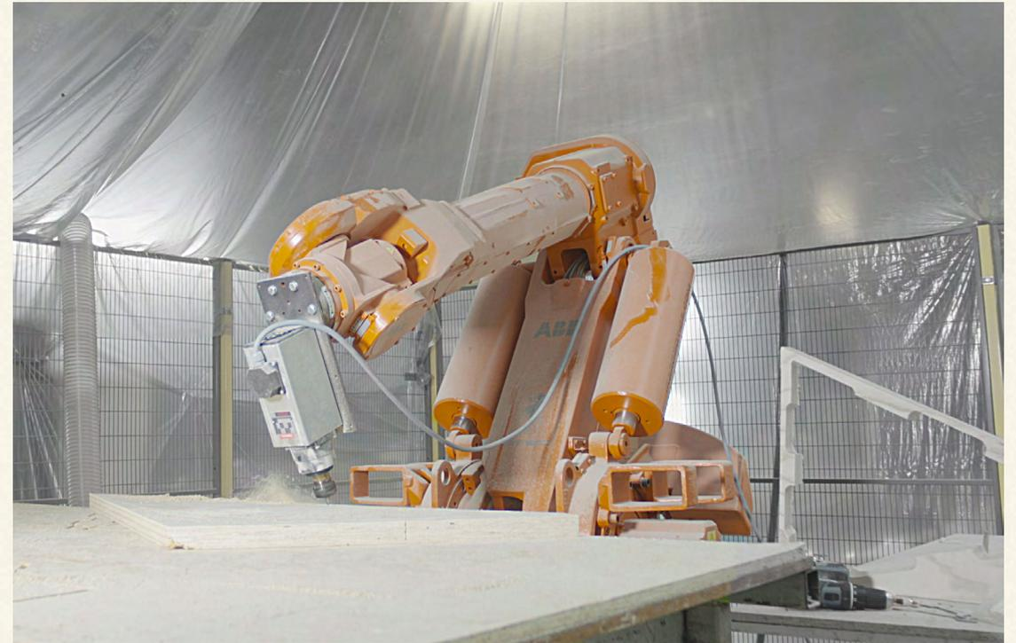
*Studio RAP - SkilledIn Office, RDM Rotterdam, braccio robotico a 6 assi di rotazione per il taglio della pannellatura lignea tramite fresa, 2016.
