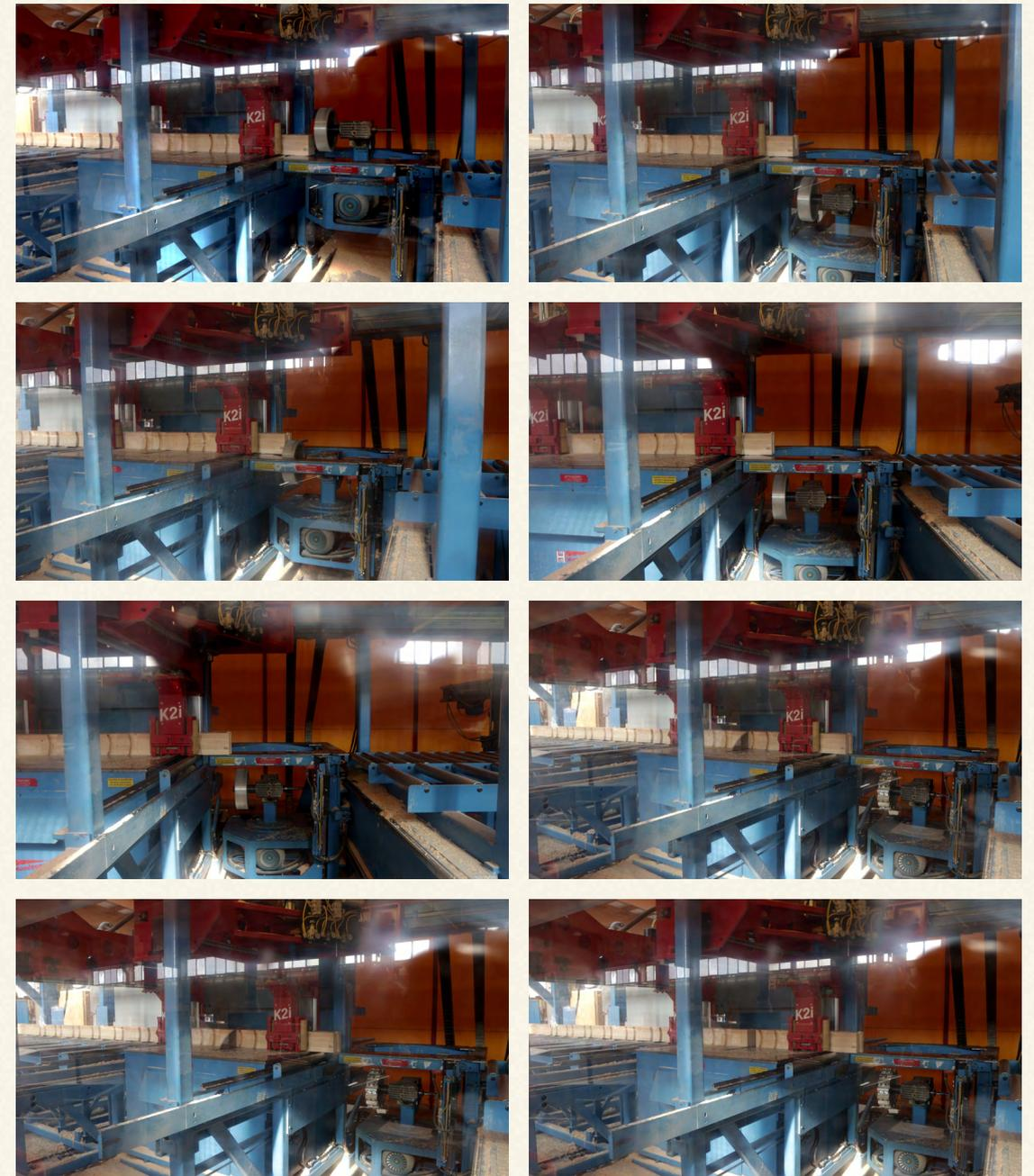
*Fase di fresatura di incastro a coda di rondine frontale "a clessidra" e successivo taglio con sega circolare verticale per la produzione del blocco LokAlp Mk XII da 960mm di lato.*
