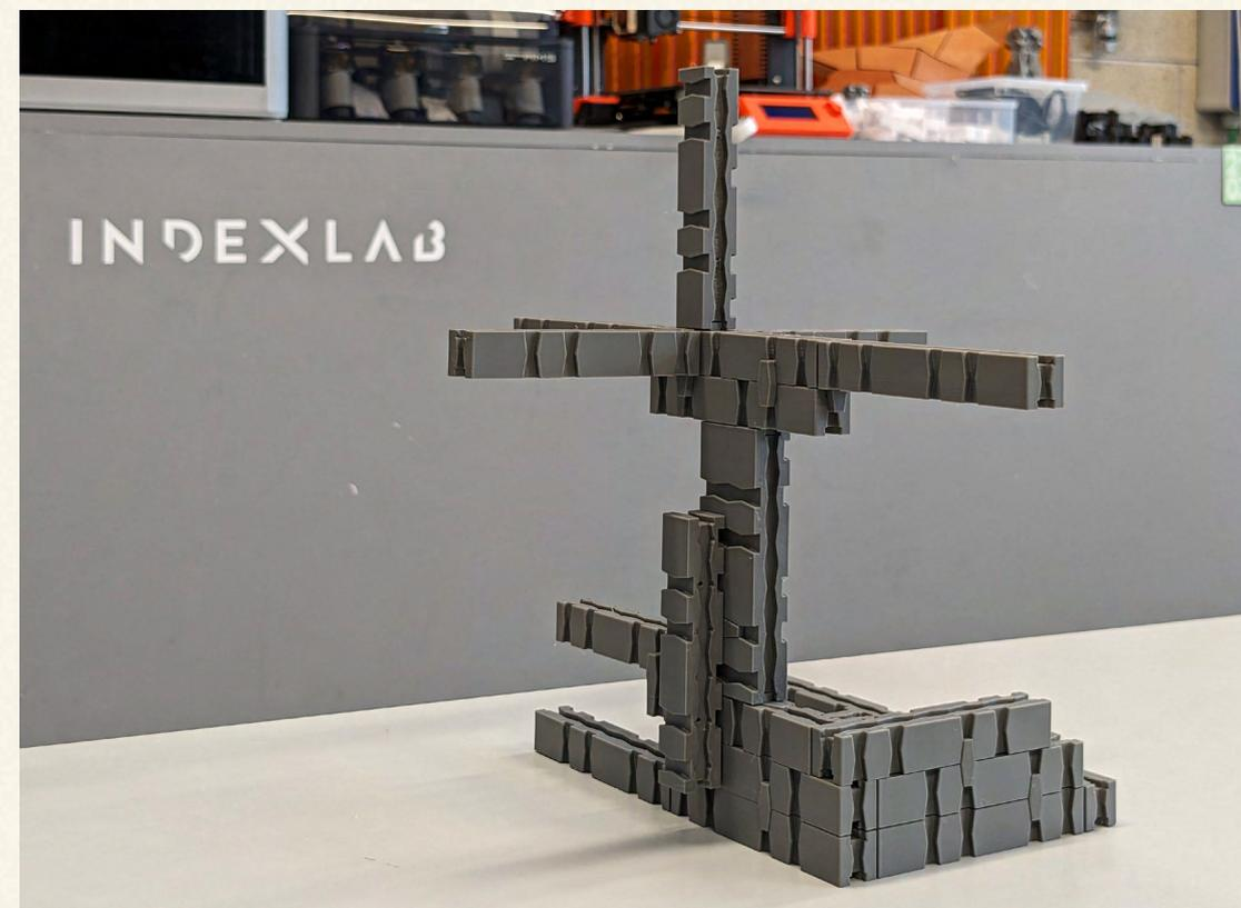
Montaggio del modellino in scala 1:10 modello Mk XI per la dimostrazione a Legnotech delle possibili configurazioni e connessioni disponibili.
