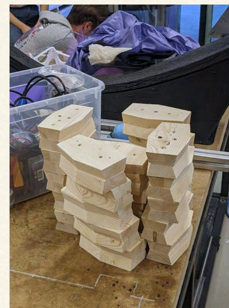
Step successivi per la produzione manuale di biscotti esagonali con coda di rondine basati su pannelli CLT da 30mm.
