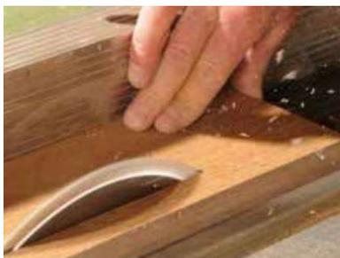
Taglio e rifinitura dei profili. Possono essere usati gli stessi strumenti impiegati per la lavorazione del legno duro.
