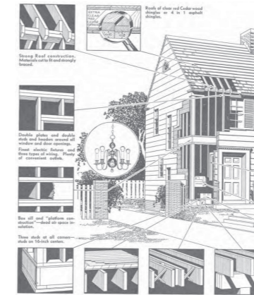
Fig.79. Sistema costruttivo a telaio delle "Sears Modern Homes". Fonte: https://dahp.wa.gov/sites/default/files/ModernHomessears1936.small_.pdf
