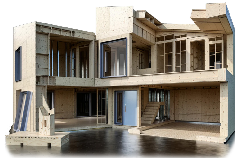
Fig.116. Spaccato prospettico del Facit Chassis di un'abitazione Facit Homes. Fonte: https://www.facit-homes.com/the-facit-home
