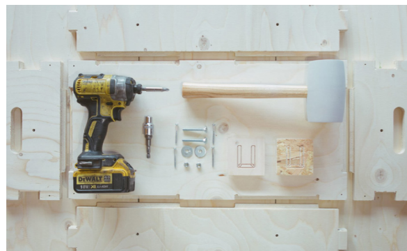
Fig.50. Componenti per l'aucostruzione di un blocco del sistema U-Build. Fonte: https://issuu.com/rumoer/docs/rumoer_72_digital_copy/s/10436700
