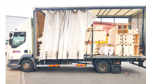
Fig.42. Trasporto dei blocchi preassemblati del sistema WikiHouse. Fonte fotogrammi da videoclip: https://www.youtube.com/watch?v=tdYBML6VCMA&ab_channel=PulpBuild
