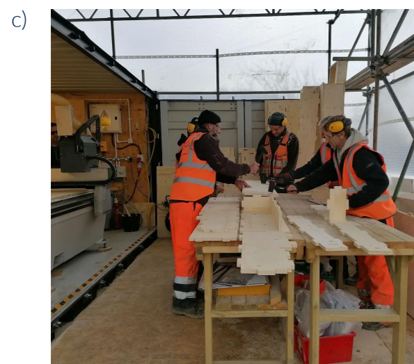
Fig.127. a) Fabbrica portatile a container "Mobile Production Facility (MPF)" dentro area di assemblaggio e stoccaggio "Ply Store". b) Taglio a macchina CNC dei pannelli in compensato. c) Assemblaggio blocchi strutturali. Fonte a: https://www.facit-homes.com/post/starting-on-site . Fonte b,c: https://www.facit-technologies.com/mobile-production
