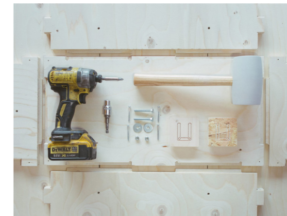
Fig.259. Componenti per l'autostruzione di un blocco in compensato U-build. Fonte: https://www.dezeen.com/2019/05/10/ubuild-studio-bark-modular-architecture/
