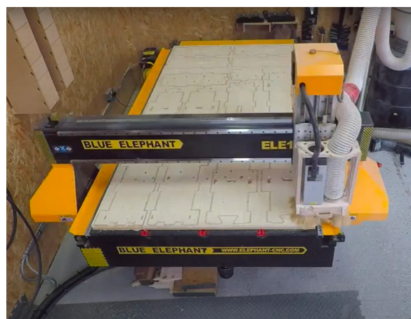
Fig.34. Taglio pannelli in compensato con macchina CNC. Fonte: https://www.wikihouse.cc/mission
