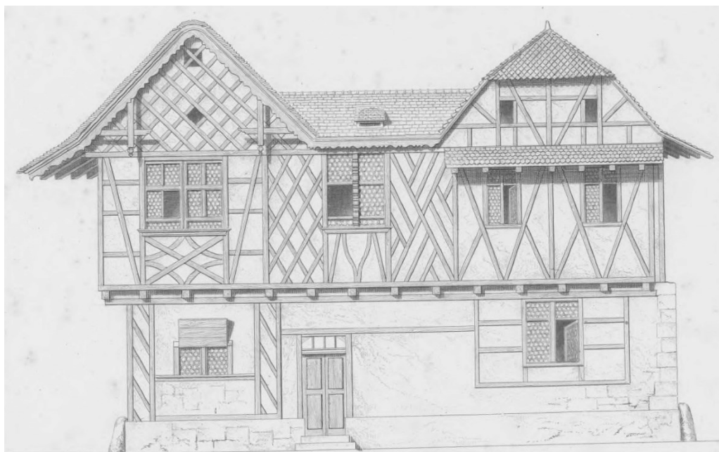
Fig. 1 Disegno di una casa a traliccio a Frauenfeld nel catone di Turgovia Da Amédée VARIN, L'architecture pittoresque en Suisse ou choix des constructions rustiques prises dans toutes les parties de la Suisse , Librairie des imprimeries réunies, Paris 1861, p. XXII
