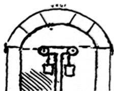
Fig. 1.6, Strumento ideato da Leonardo da Vinci per misurar la spinta dell'arco esercitata alle imposte. R. Marcolongo, *Studi Vinciani... op. cit.* in M. Como, *Statica delle costruzioni... op. cit.*, p. 211.
