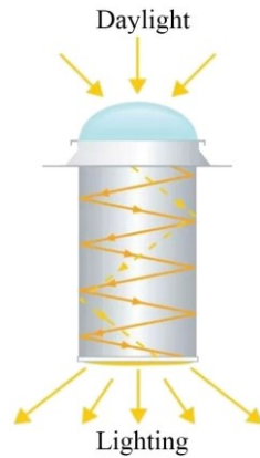
Figure 5.3. Functionality of a light tube ( Sunvia Güneşli Doğal Aydınlatma Uygulamaları - Erdinç Klima (erdincklima.com.tr) )
