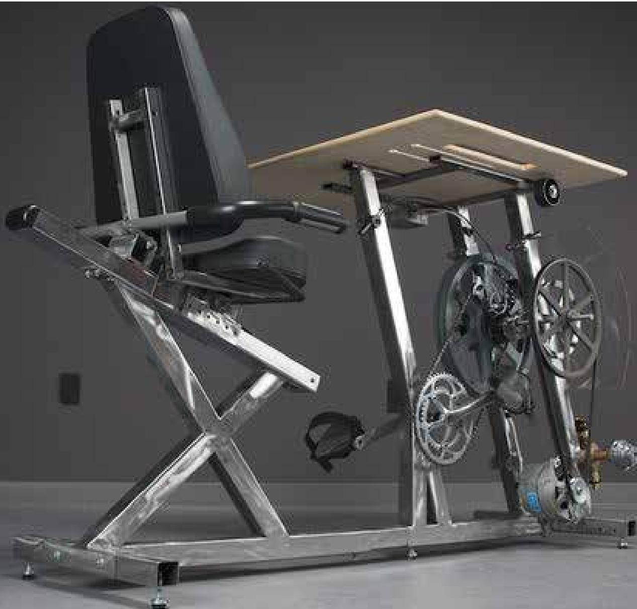
Big Rig è un macchinario azionato dalla pedalata umana composto da un asse principale a cui sono collegati un volano e una puleggia. Oltre al meccanismo è presente una seduta regolabile e un piano di lavoro al quale si possono applicare diversi apparati in base alle necessità.
