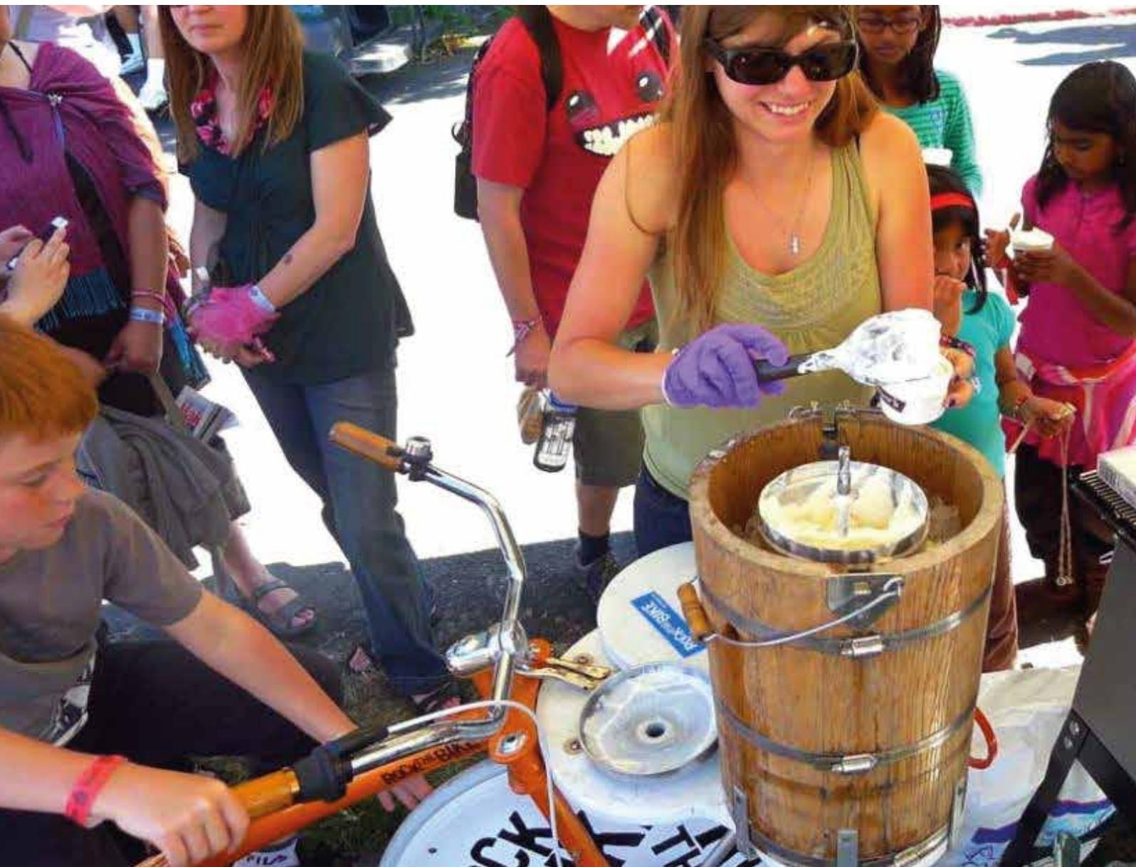
La creazione di Rock The Bike è costituita da una gelatiera artigianale composta da un guscio esterno in legno contenente il ghiaccio ed un guscio interno in acciaio contenente il gelato. Grazie alla pedalata il guscio interno ruota raffreddando il contenuto.
