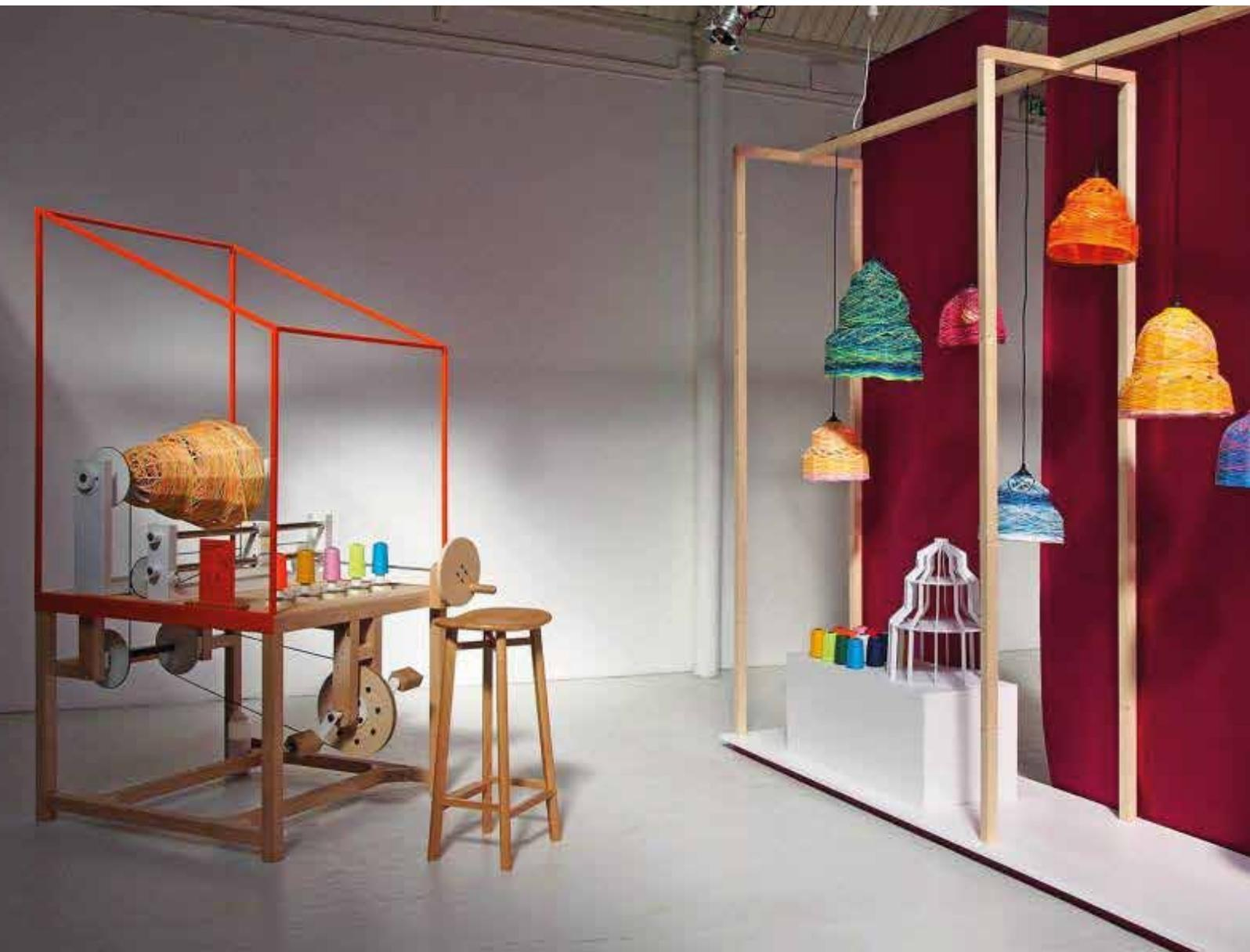
Realizzazione di lampade personalizzate ma che mantengono una efficiente serialità nella produzione. I materiali di cui è composta la lampada sono uno scheletro in PVC e del filo di cotone impregnato di colla.
