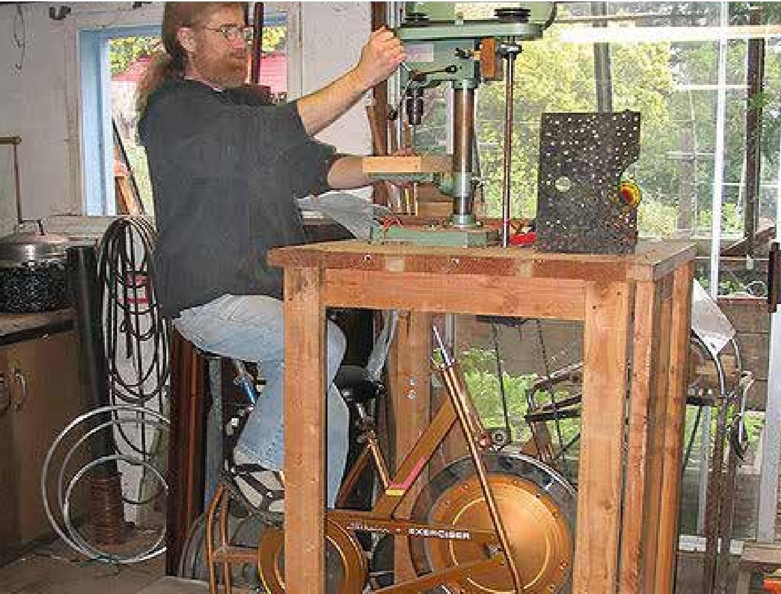
Il trapano a colonna è costituito da una ciclette riadattata e un trapano a colonna tradizionale posizionato su di un tavolo. Le due parti principali si collegano tramite elementi che permettono il corretto funzionamento.
