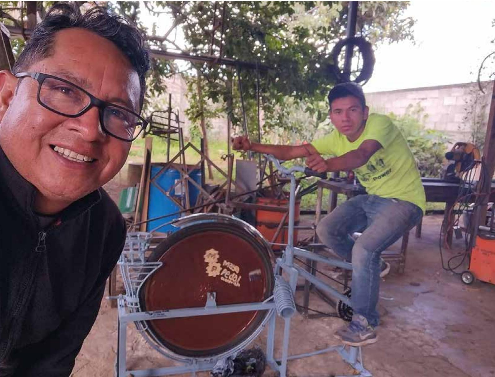
La macchina è composta da un telaio su cui è montato un volano, costituito da una ruota di bicicletta appesantita con il cemento. Lo pneumatico dentato della ruota, girando, spinge le noci sul fondo di una gabbia metallica, sgusciandola. Attraverso un'apertura della gabbia si separano le parti.
