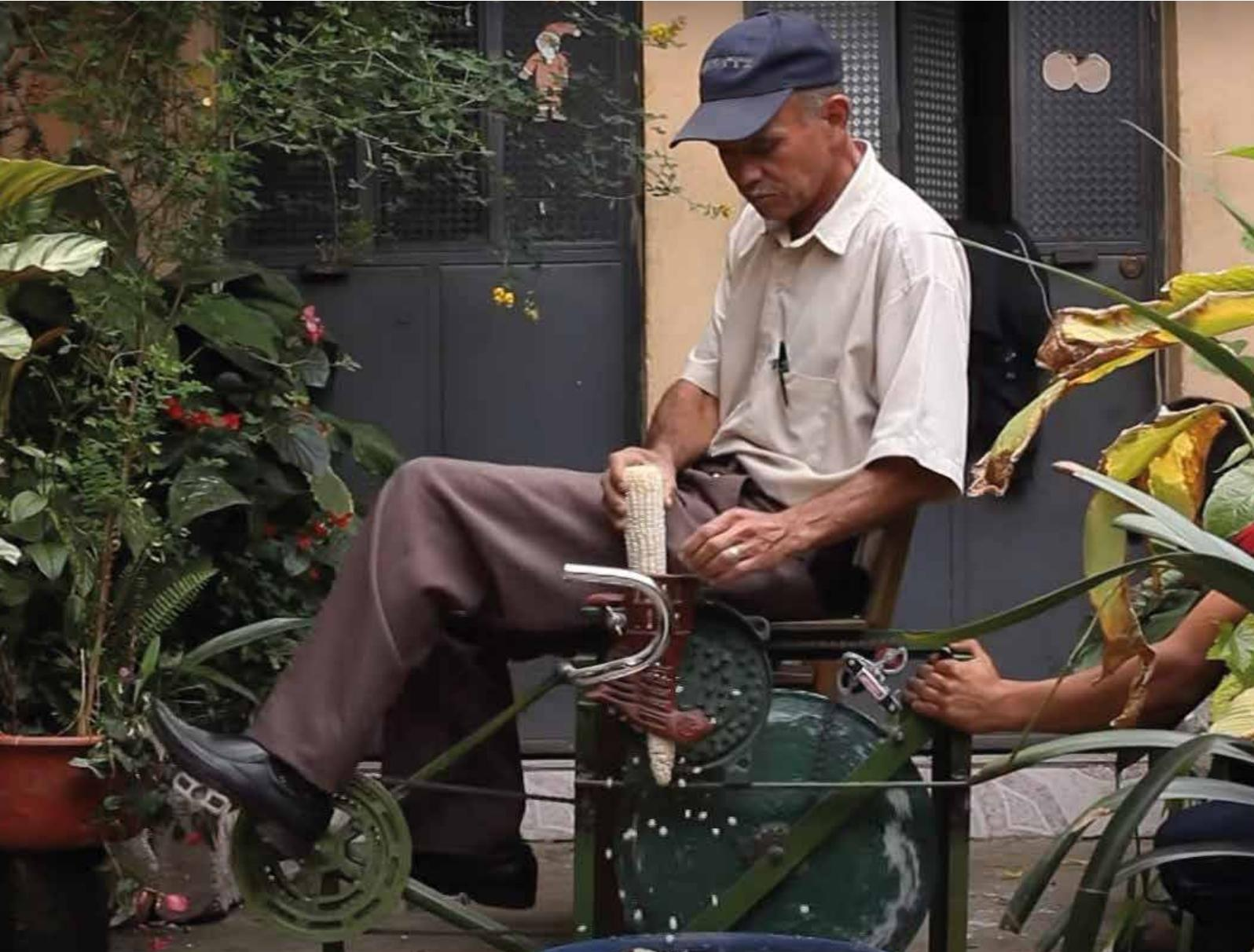
In foto si mostra una struttura metallica provvista di seduta e di fronte i pedali per generare il moto necessario a sgranare le pannocchie. L'utilizzo di un macchinario prefabbricato come lo sgranatore agevola molto la realizzazione.
