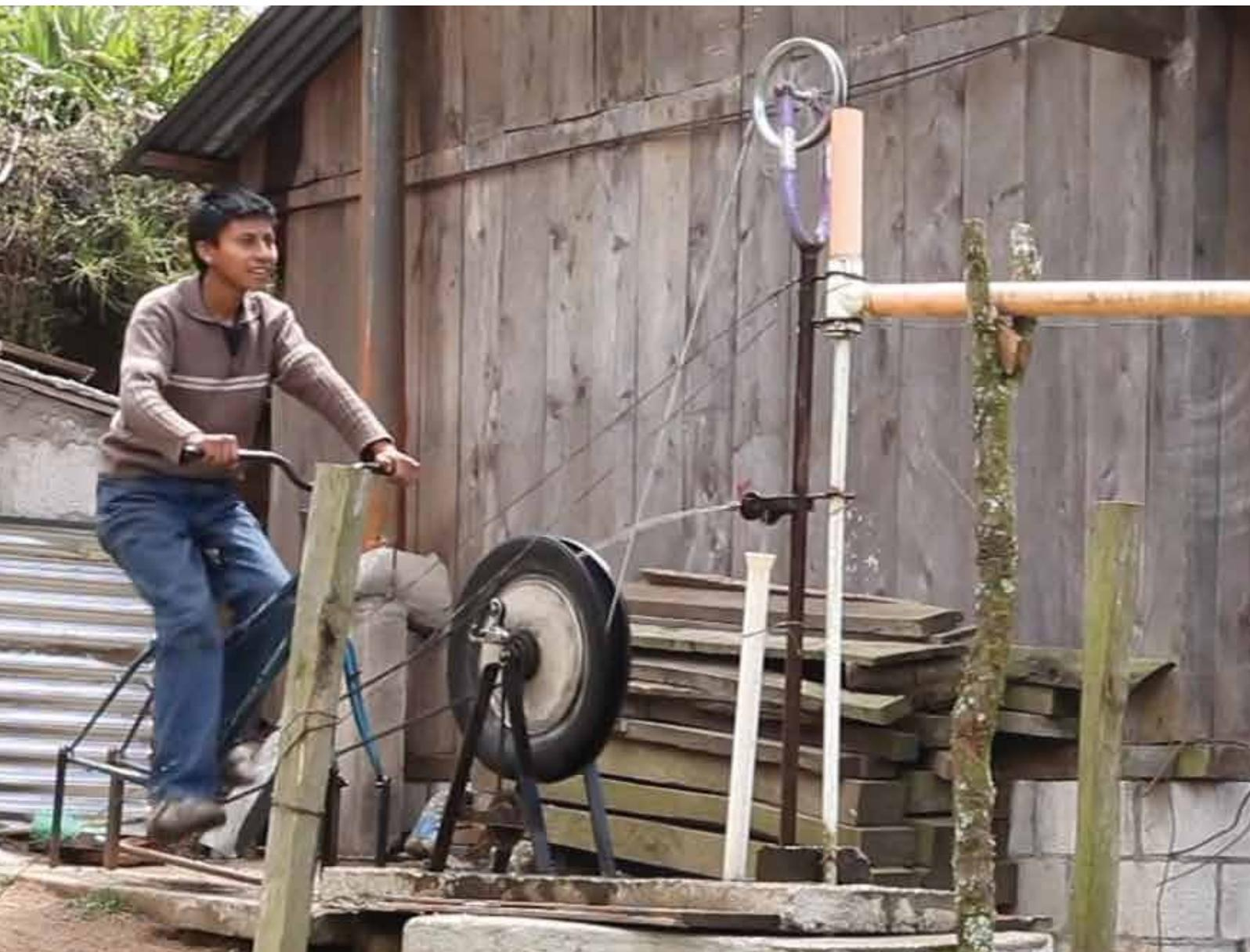
La Bicibomba, o pompa a pedali è costituita da una bicicletta giuntata ad un telaio fisso. Con la semplice pedalata viene dato il movimento alla ruota che aziona il filo costituito da tappi posti a distanza costante per tutta la lunghezza. Questi ultimi trasporteranno l'acqua nelle tubature.
