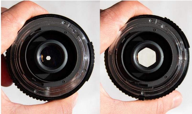
Figura 29: Lamelle con diaframma chiuso (sinistra) e aperto (destra)
