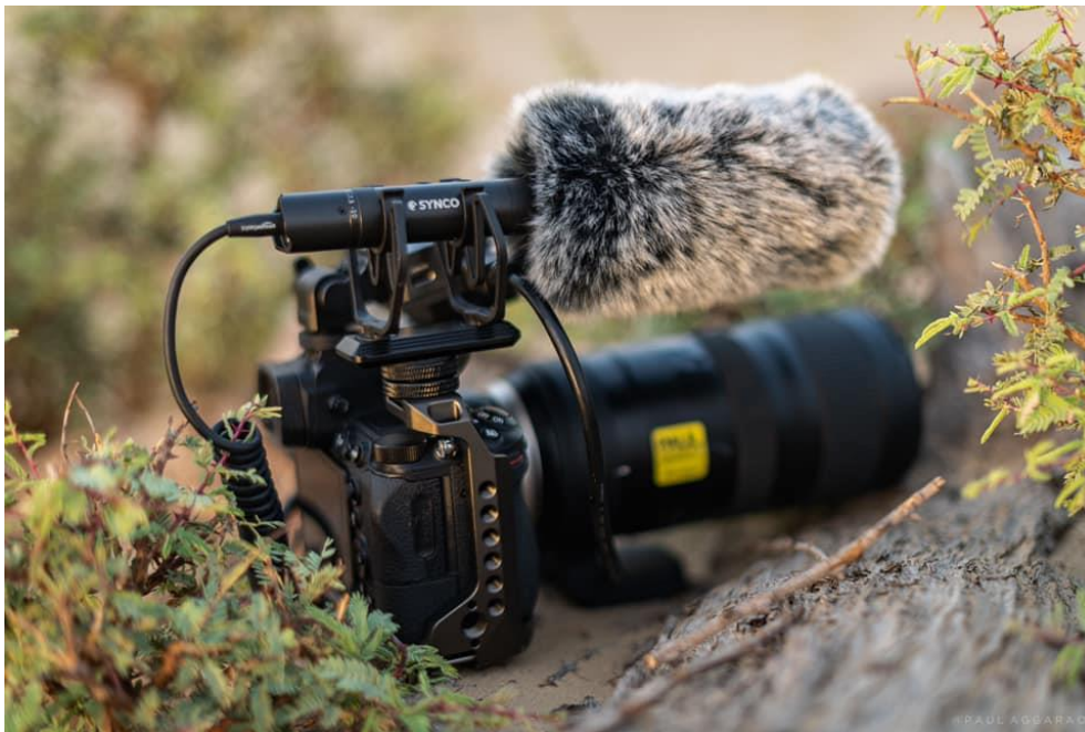
Figura 11: Microfono shotgun montato su una camera
