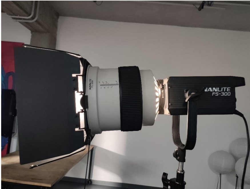
Figura 7: Nanlite FS-300 con montata una lente fresnel
