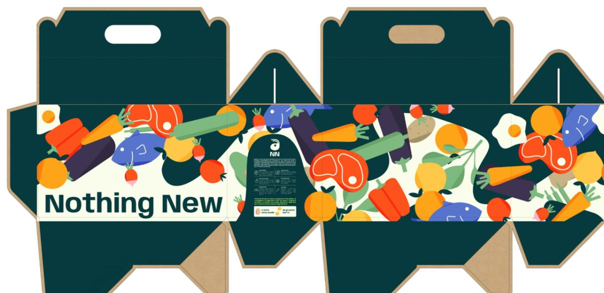
Figura 86. vista ortogonale dello sviluppo dell'esterno della Box.
