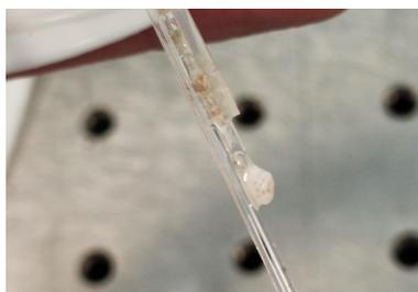
**Figura 11.3:** Estremità terminale della fibra di delivery con addensamento dell'albume d'uovo.
