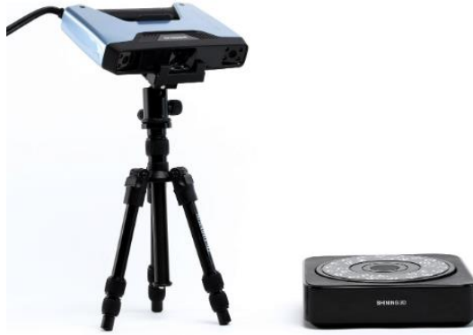
Figura 39. Configurazione per la scansione automatica
