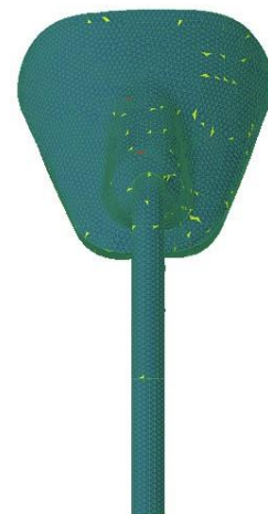
Figura 20. Analisi della qualità degli elementi dei componenti del modello
