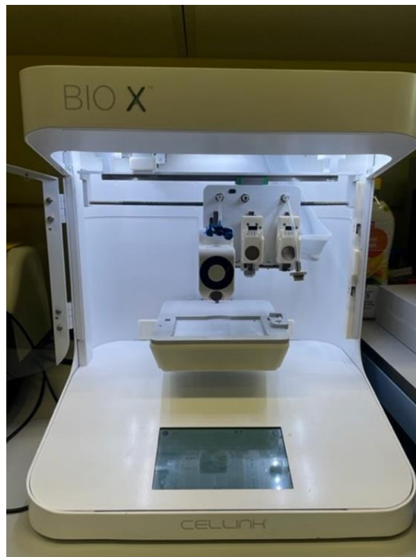
Figura 24: BIOX (Cellink) con montata la testina a temperatura controllata per l'estrusione del materiale.
