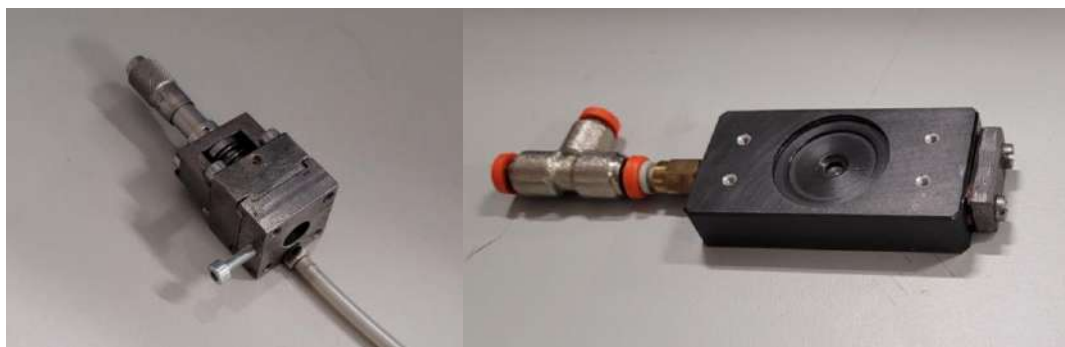
Figura 2.1: fotografia valvola a membrana e pattino.
