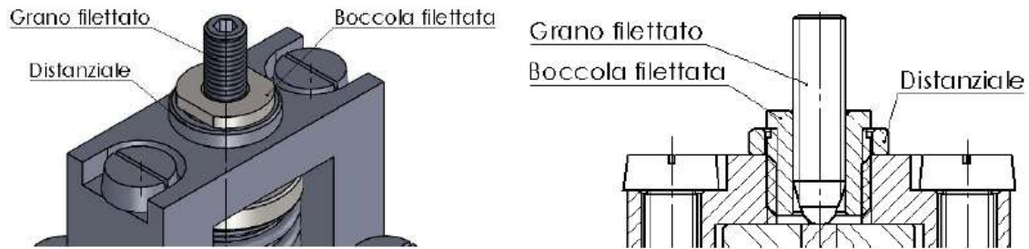
Figura 2.15: sistema di regolazione con boccola e grano filettato.
