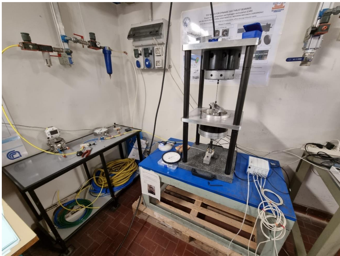
Figura 2.25: fotografia del banco prova per prove statiche e dinamiche sul pattino.
