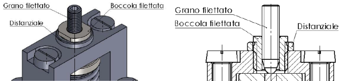
Figura 2.15: sistema di regolazione con boccola e grano filettato.
