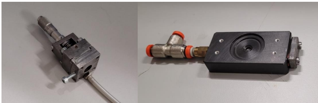
Figura 2.1: fotografia valvola a membrana e pattino.
