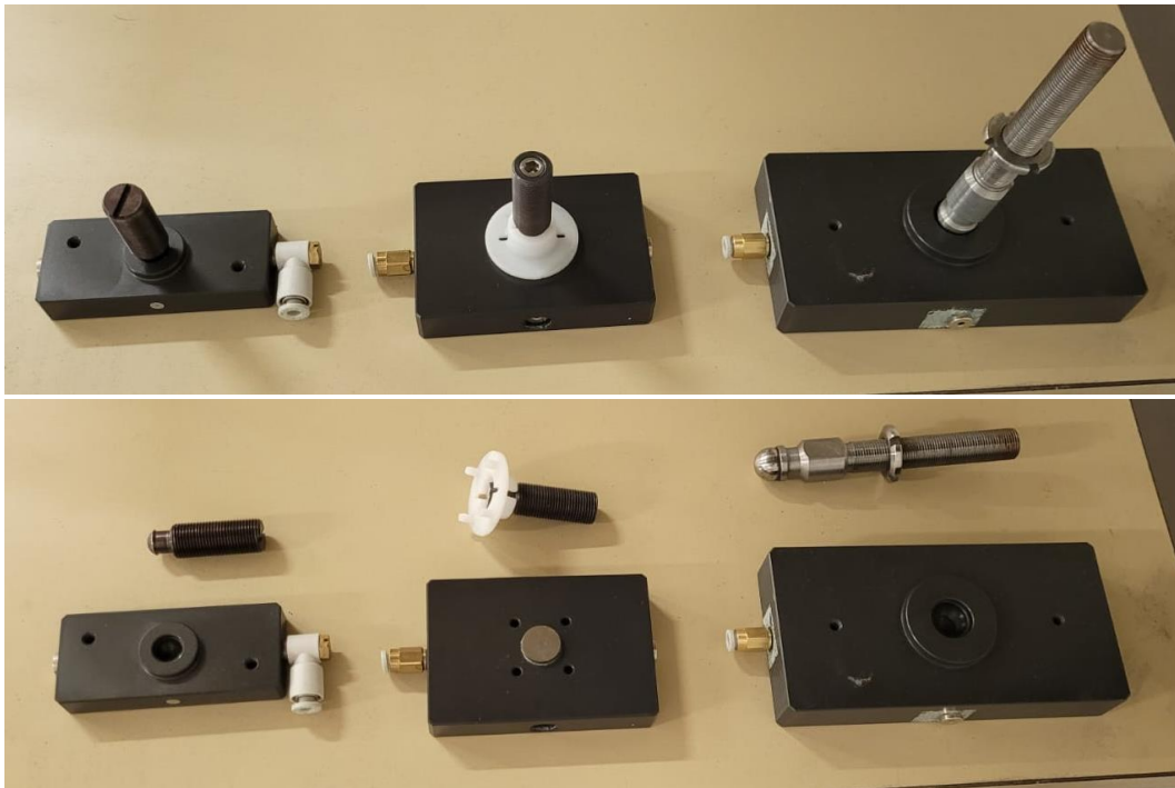
Figura 2.26: fotografie di diverse tipologie di pattino con i rispettivi puntali.
