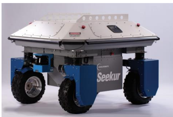
Figura 69: Robot Seekur (Mobilerobots) dotato di ruote robotiche [45]
