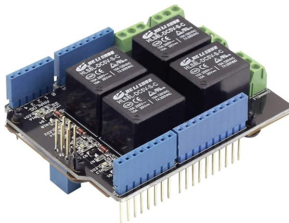
Figura 29: Shield Relè compatibile con Arduino [34]
