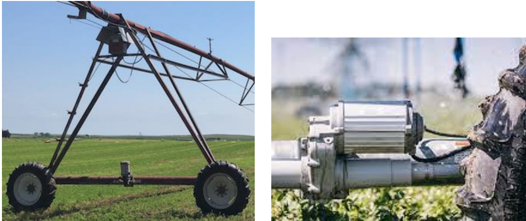
Figura 64: Torre di movimentazione Reinke (sx) [41], "Drive center" Valley (dx) [42]
