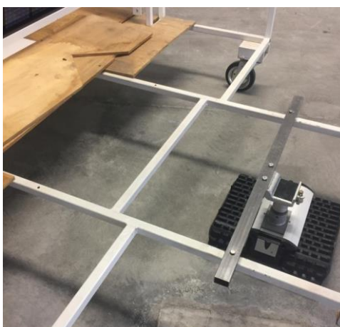
Figura 26: Integrazione meccanica tra robot e carrello
