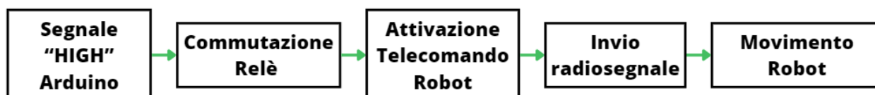
Figura 30: Schema flusso segnale da Arduino al Robot
