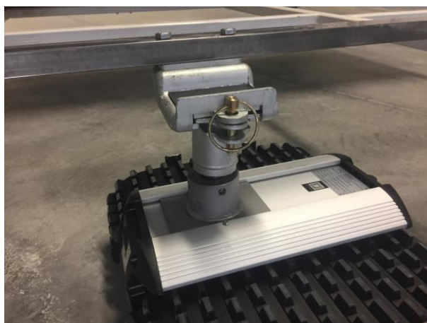
Figura 27: Dettaglio connessione meccanica tra robot e carrello
