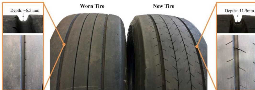
Figura 2.2.4 Pneumatico usurato e pneumatico nuovo utilizzato nella misurazione da [12]
