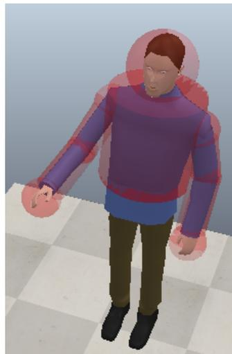
Figura 3.28: Manichino approssimato da sfere e cilindri nella parte superiore del corpo
