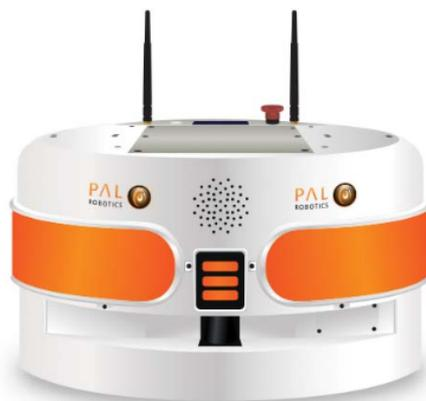
Queste caratteristiche permettono a questo robot mobile di poter operare in prossimità di una o più persone. Come effettuato in uno studio, il robot è equipaggiabile con elementi esterni come un microfono, un display LED e anche un cargo box [17]. Altri elementi con cui il TiaGo Base può essere integrato sono prodotti dalla Pal Robotics e in base ad esso, il TiaGo Base viene chiamato in un altro modo. Le varianti più comuni sono le seguenti:
