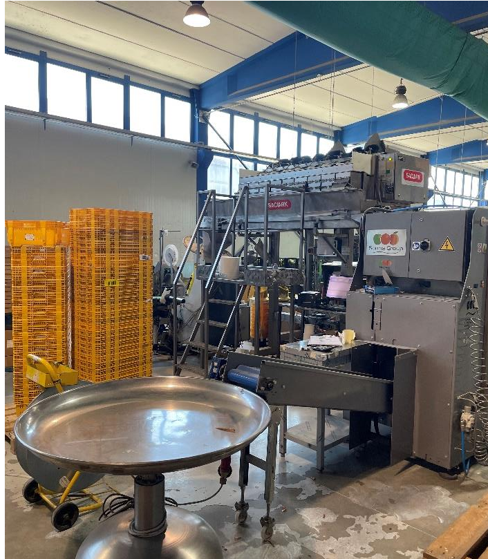
Figura 17: Filmatrice-etichettatrice Fonte: foto scattate in azienda
