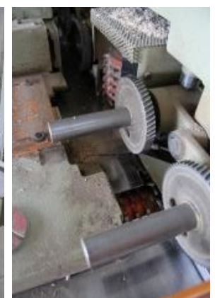
Figura 18: A sinistra la pialla classica e la pialla a spessore, mentre a destra la scorticatrice con in aggiunta una foto di dettaglio dei suoi taglienti.
