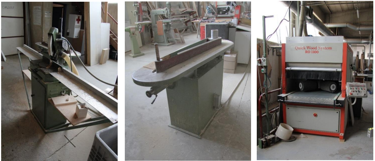
Figura 22: Rispettivamente da sinistra verso destra la troncatrice, la carteggiatrice a nastro e la spazzolatrice.
