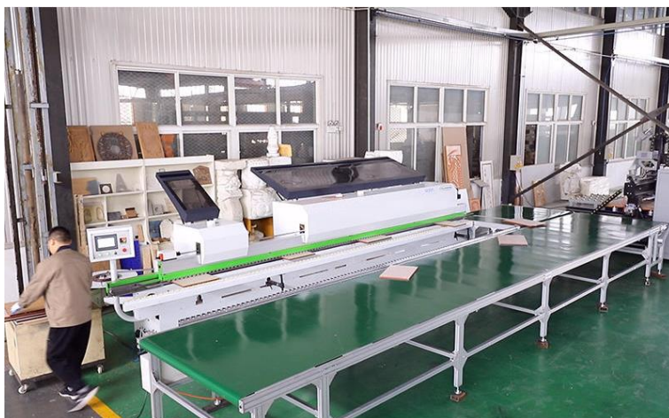
Figura 41: Configurazione bordatrice con nastro trasportatore [24].
