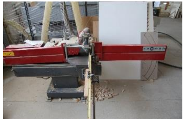
Figura 19: A sinistra la mortasatrice e a destra la tenonatrice.
