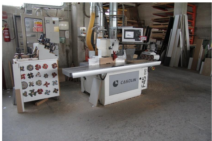
Figura 20: A sinistra la bordatrice Elwood KS4600, mentre a destra la Casolin F45, macchina toupie affiancata da una serie di frese
