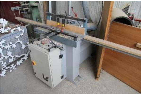
Figura 19: A sinistra la mortasatrice e a destra la tenonatrice.
