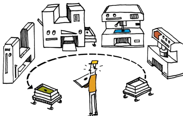
Figura 5: Esempio disposizione a "U" in una cella [12]
