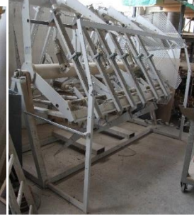
Figura 17: A sinistra sega a nastro, a destra: pressa per pannelli, pressa per tavolati e pressa per ante.
