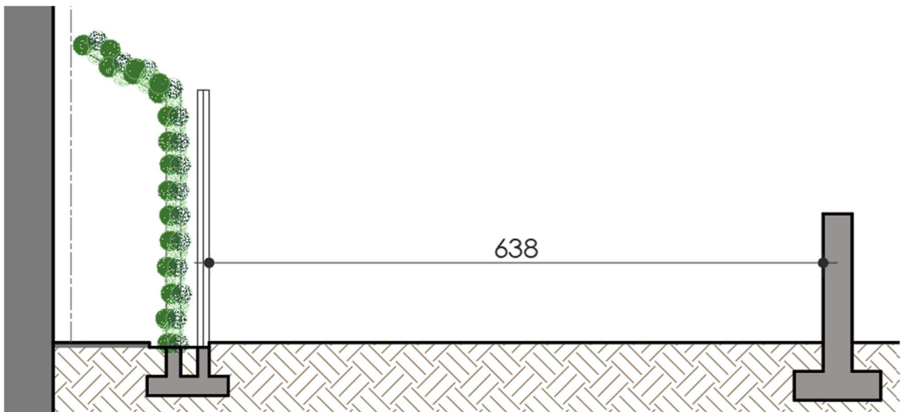
Figura 168: Larghezza accesso alla nuova cabina di trasformazione all'aperto, documento dell'autore
