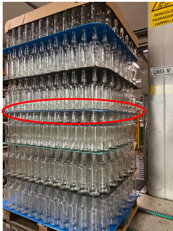
Figura 23. Esempio di bancale con le interfalde per separare i piani di bottiglie
