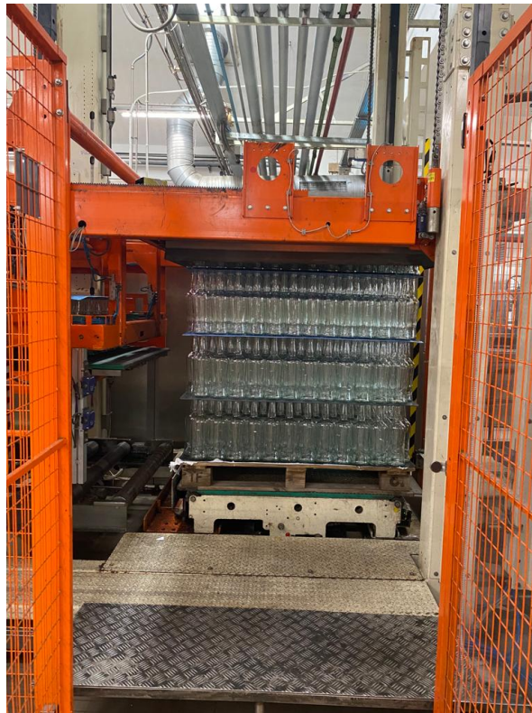
Figura 26. Testa che afferra il piano di bottiglie
