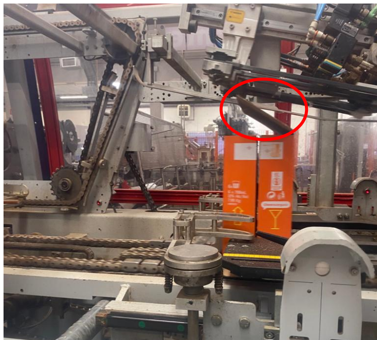
Figura 29. Lembo laterale che può rimanere aperto durante la fase di chiusura
