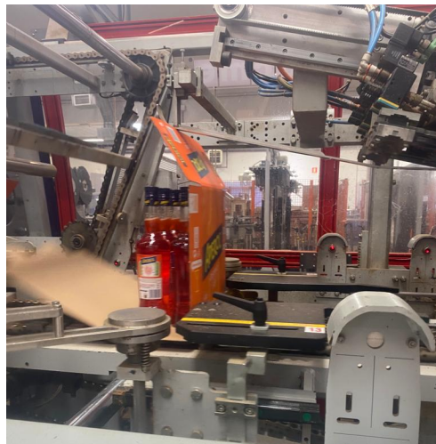
Figura 13. Macchina OCME, con dettaglio sul metodo di incartonamento di tipo wrap around
