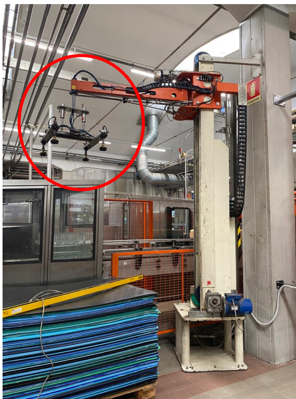
Figura 24. Braccio meccanico con il compito di rimuovere l'interfalda
