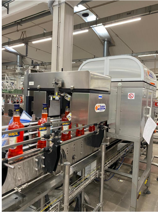
Figura 12. FT System, sistema di fotocellule per il controllo qualità sotto vari aspetti
