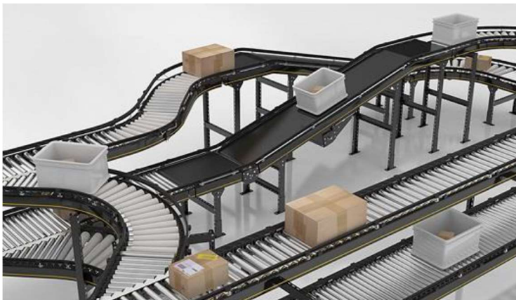
Figura 2. 1 - Sistema di movimentazione colli su rulliere
