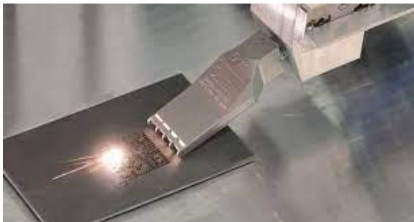
Figura 2: Tecnologia di marcatura laser nata dalla sinergia tra l'azienda Ridix S.p.A e M-Pix S.r.l. Tale procedimento consente una marcatura più profonda dei pezzi metallici e abbatte significativamente i tempi di incisione rispetto alle altre tecnologie disponibili ad oggi. È, infatti, possibile raggiungere profondità di marcatura che vanno oltre i 0,3 mm, grazie all'utilizzo di innovative sorgenti a fibra con impulsi molto energetici e potenze che variano dai 150 ai 1.000W a seconda dell'applicazione e del tipo di metallo.
