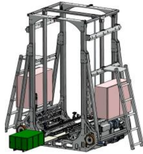
Figura 4.4 - Maxi Shuttle presente all'interno del magazzino automatico
