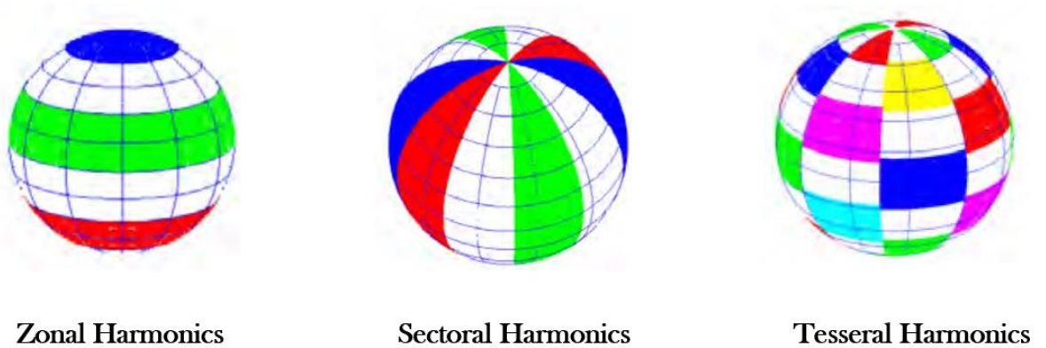
Figura 18: rappresentazione schematizzata dell'andamento delle diverse armoniche sulla superficie terrestre.
