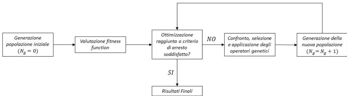
Figura 23: generico diagramma di funzionamento degli algoritmi genetici. Il termine N_g indica il numero della generazione corrente.
