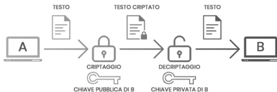
Schema del flusso di un messaggio cifrato con crittografia asimmetrica.
