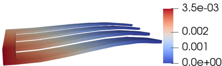
Figura 4.16: Struttura deformata sotto l'azione del carico di 1000 N. I colori e i valori numerici rappresentano l'entità dello spostamento (in metri).
