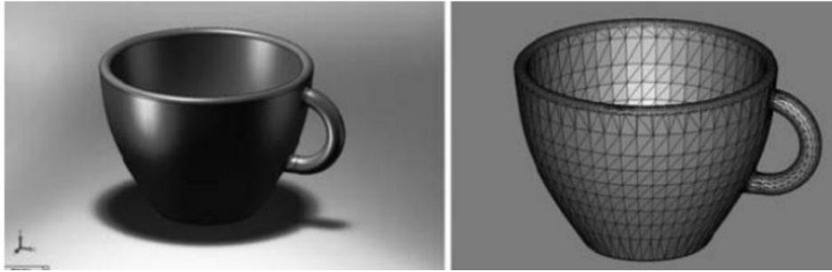
Figura 3.1: Un modello CAD (sinistra) convertito in formato file STL (destra) [1]
