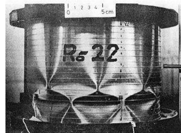
Formazione di lobi (fold) che provocano flessione sul mantello di un cilindro in parete sottile, previsione e prova
