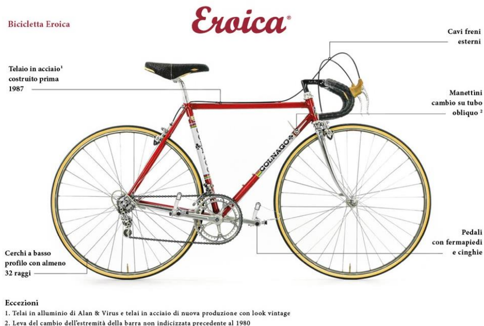
Figura 10: caratteristiche principali di una bici da corsa precedente agli anni '80.
