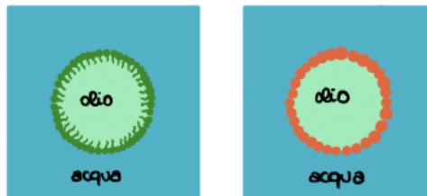
Figura 2: differenze nel metodo di stabilizzazione da parte di tensiattivi e particelle solide sferiche
