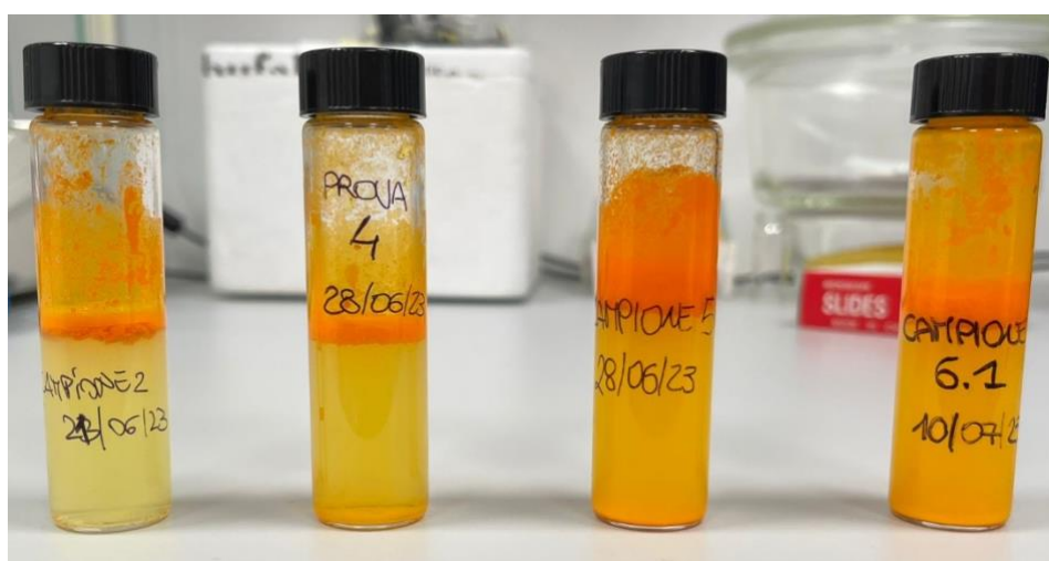
Figura 67: emulsioni olio in acqua dopo tre mesi dalla realizzazione
