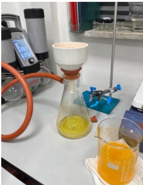
Figura 21: filtrazione con pompa da vuoto
