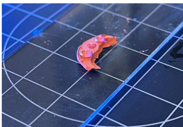
Figura 48: pellet di curcumina dopo deposizione di due gocce d'acqua a pH 3 (alle estremità) ed una centrale di acqua a pH neutro
