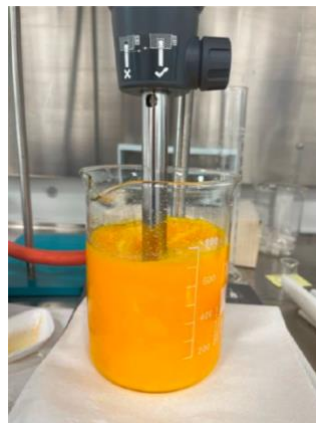
Figura 20: soluzione in agitazione con Ultraturrax
