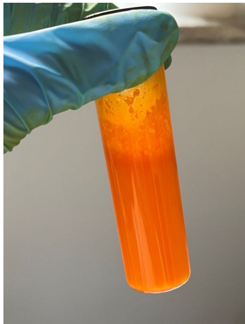
Figura 5.49: Immagine del campione 5, in cui è visibile uno strato di cristalli non disperso in superficie
