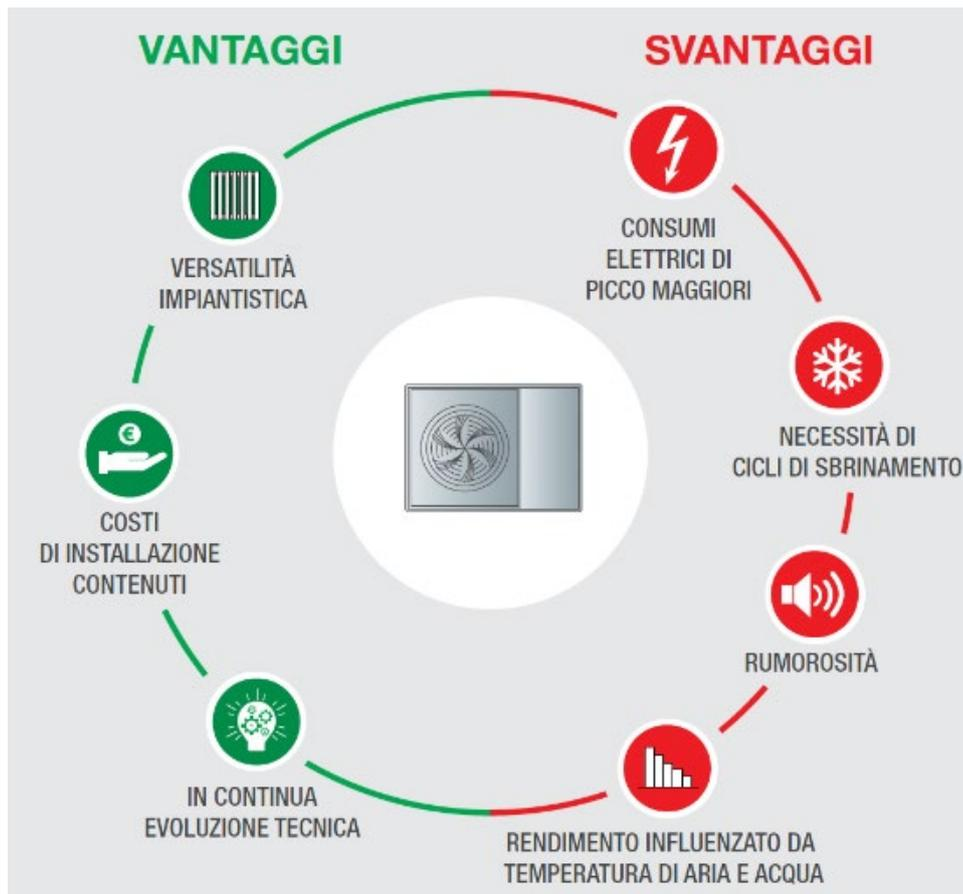
Figura 26: Vantaggi e svantaggi nell'utilizzo di una PdC aria-acqua [31]
