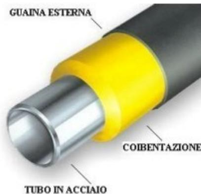
Figura 2: Sezione di una tubazione di una rete di teleriscaldamento [6]
