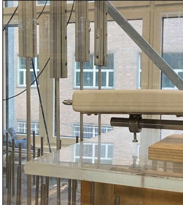
*Figura 20 – Calibrazione delle celle di carico con l'utilizzo del dinamometro*
