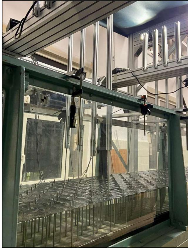
*Figura 13 – Particolare del setup sperimentale: vista laterale del canopy e delle celle di carico*
