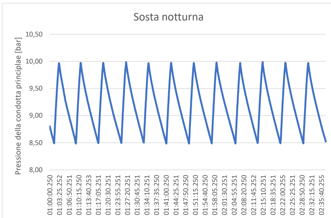
Figure 31: variazione della pressione della condotta principale
