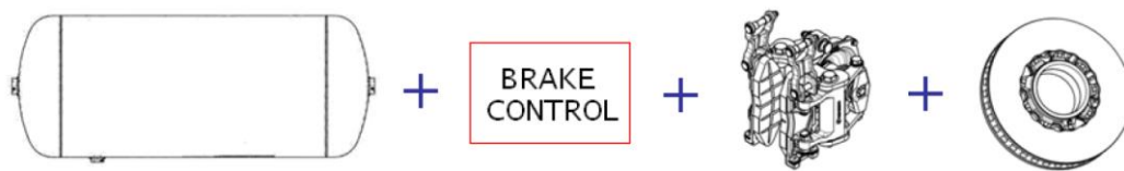
Figure 1: la domanda di frenatura è realizzata dall'aria compressa che agisce sulle pinze e sui dischi del freno; Fonte: "Wabtec documentation"
