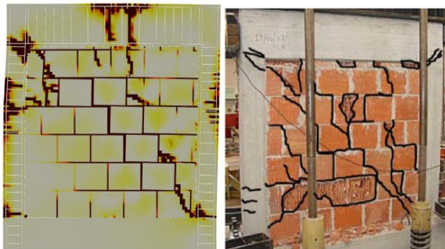
Figura 3.14 – Confronto tra danneggiamento numerico e sperimentale del provino S1B
