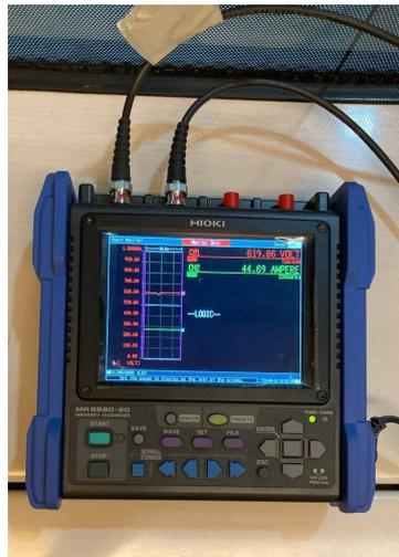
Figura 54: Strumento di Misura e Registrazione di Tensione e Corrente
