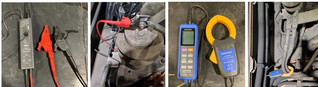
Figura 56: Sensori di Tensione e Corrente montati al Pantografo della Motrice
