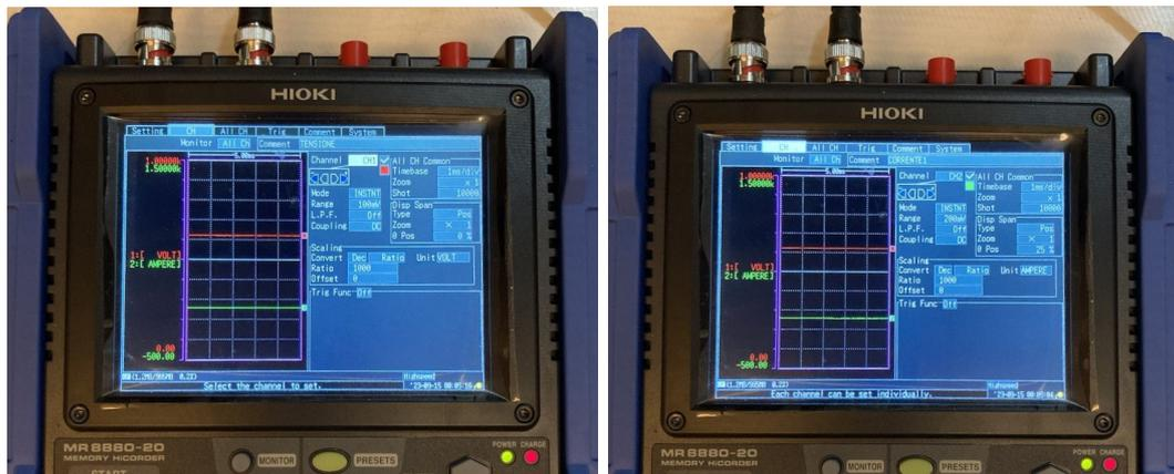
Figura 58: Impostazioni dei Canali di Tensione e Corrente
