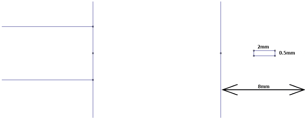
Figura 36: Dimensioni del difetto LF e della pipeline.
