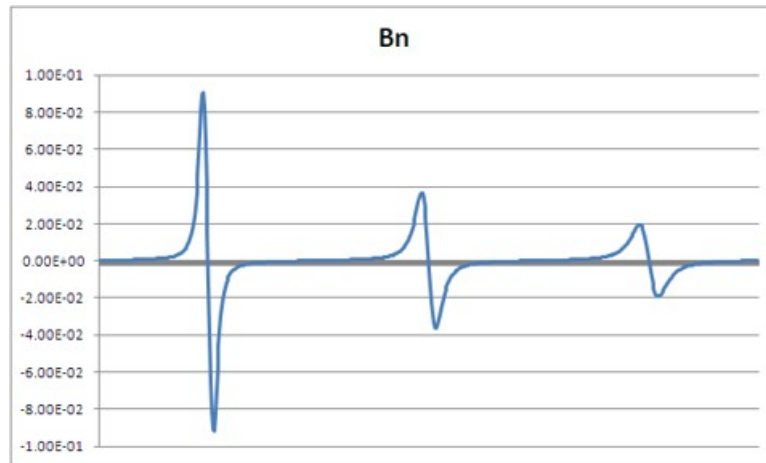
Figura 22: Valori di flusso magnetico normale (o radiale) misurati a 1-2-3 mm dal materiale saturo.
