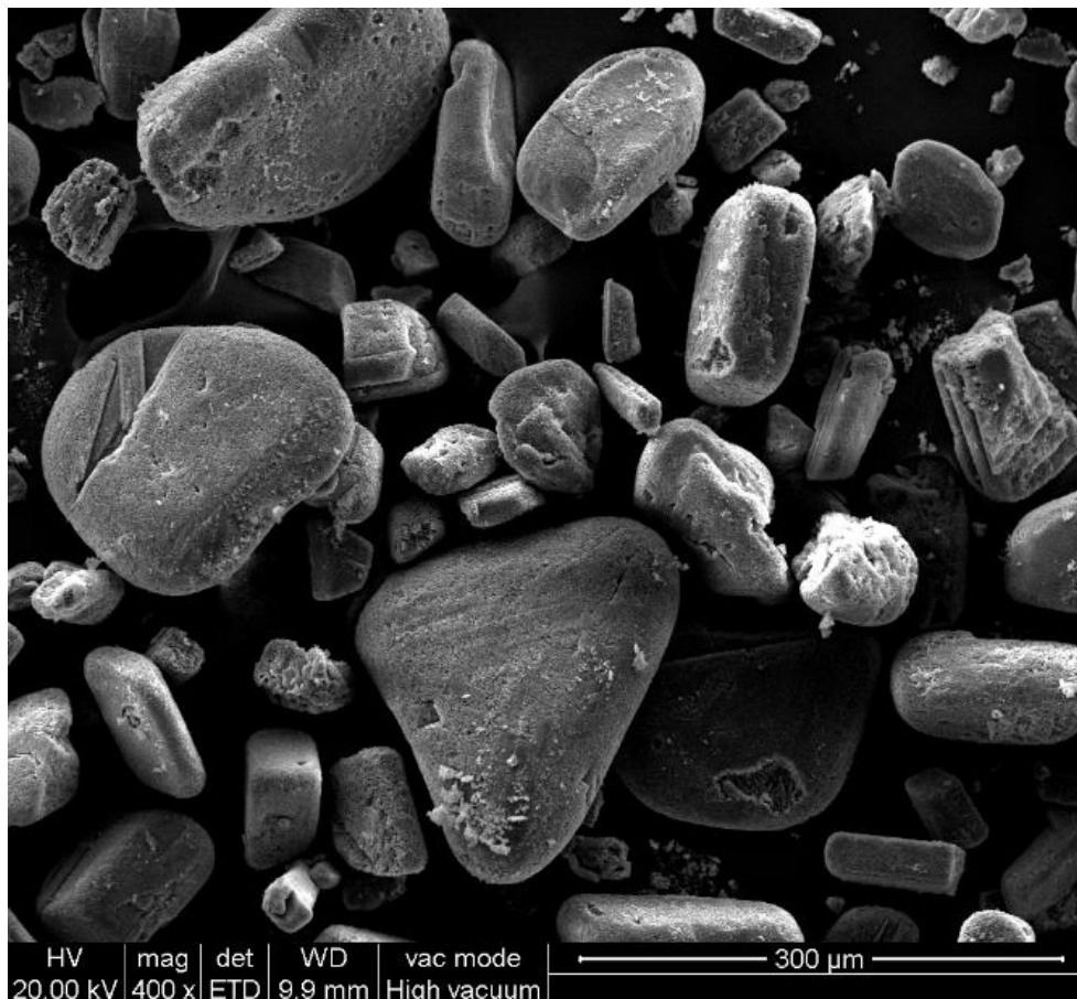
Figura 63. Acquisizione a più basso ingrandimento di Campione 9 post-prova di assorbimento (150°C)
