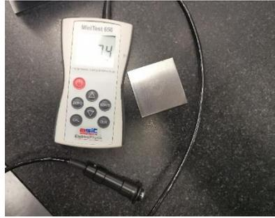
Figura 9.15 Strumento per la misura dello spessore del rivestimento
