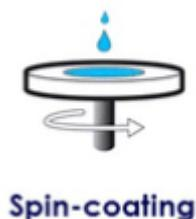
Figura 10.16 Tecnica di Spin-coating
