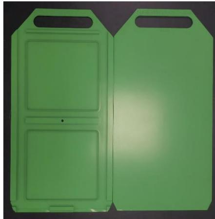
*Figura 1.1 Elementi di uno stampo usato per la cottura di provini di mescola, base a sinistra, coperchio a destra.*
