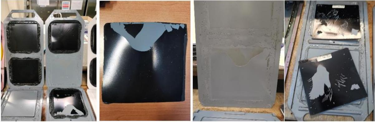
*Figura 11.8 Stato del rivestimento dopo diverse cotture*
