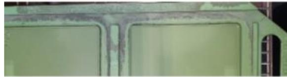
Figura 9.5 Usura rivestimento di Teflon
