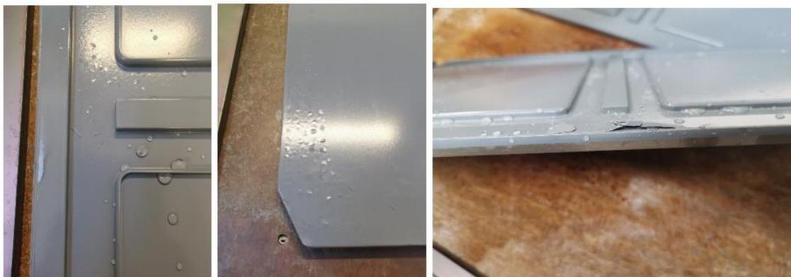
*Figura 11.5 Stato del rivestimento dopo le prime cotture*
