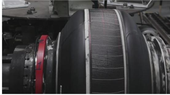
*Figura 4.12 Operazione di gonfiaggio nel tamburo*
