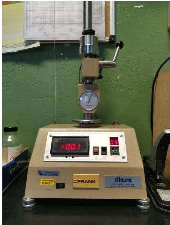
*Figura 8.1 Strumento usato per le prove di durezza, Shore A*
