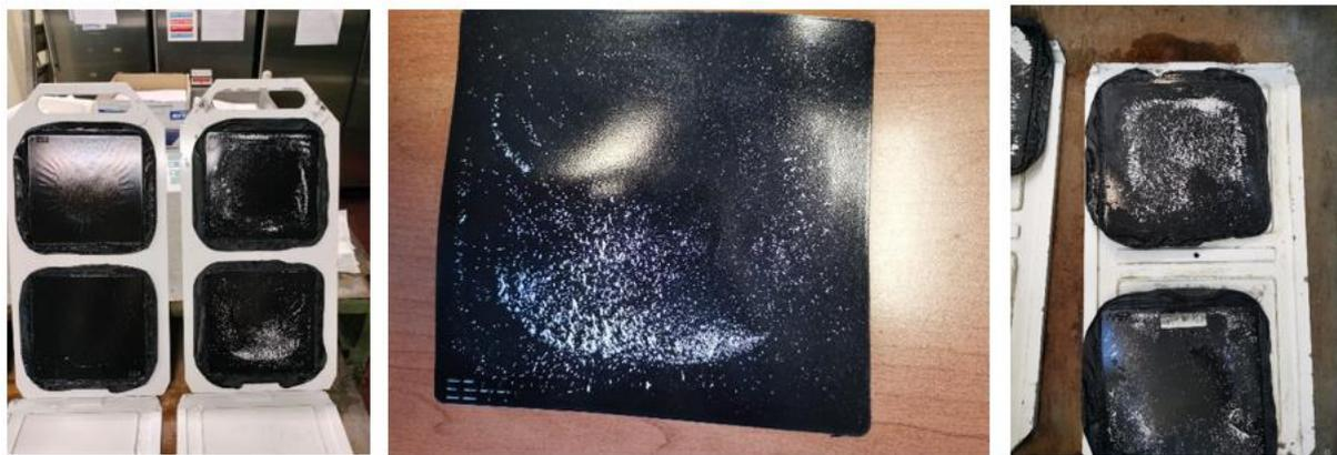
*Figura 11.10 Stato del rivestimento ceramico dopo diverse cotture*
