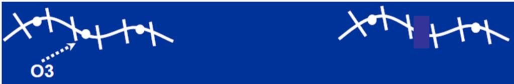
*Figura 5.11 Azione dell'ozono sulle catene polimeriche*
