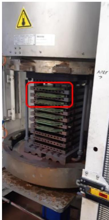
*Figura 8.18 Autoclave per cottura delle placchette*
