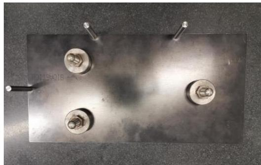
*Figura 9.14 Supporto a tre perni usato per poggiare elementi dello stampo*
