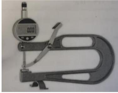
*Figura 8.12 Strumento di misura per spessore*
