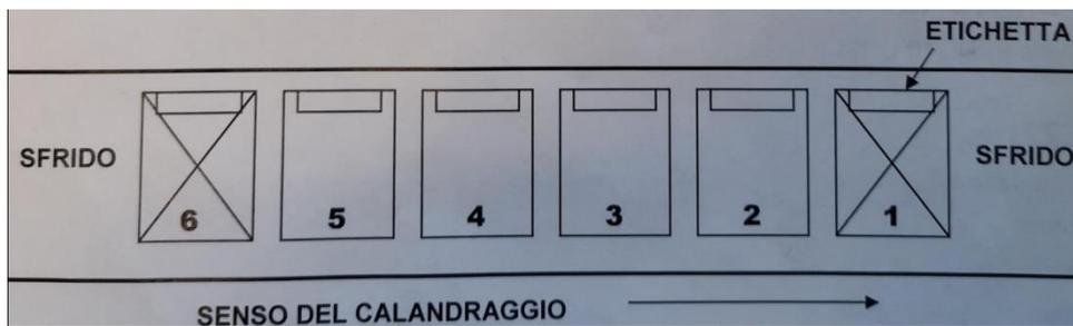
*Figura 8.16 Skim con schematizzazione delle 6 placchette*
