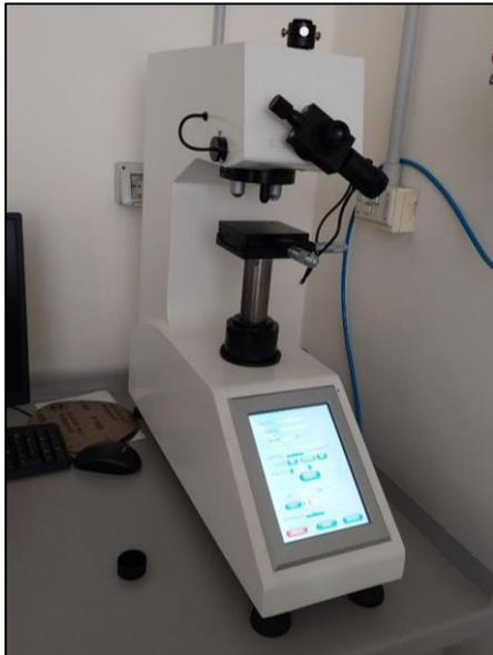
FIGURA 27: MICRODUROMETRO VICKERS
