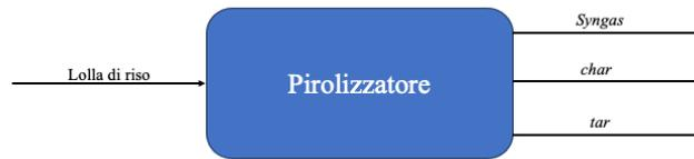
Figura 1 Schema di reazione pirolizzatore
