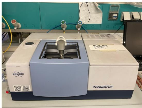
Figura 15 Immagine apparecchiatura spettroscopia IR
