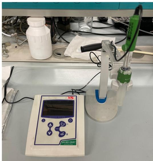
Figura 7 pHmetro utilizzato nelle misure
