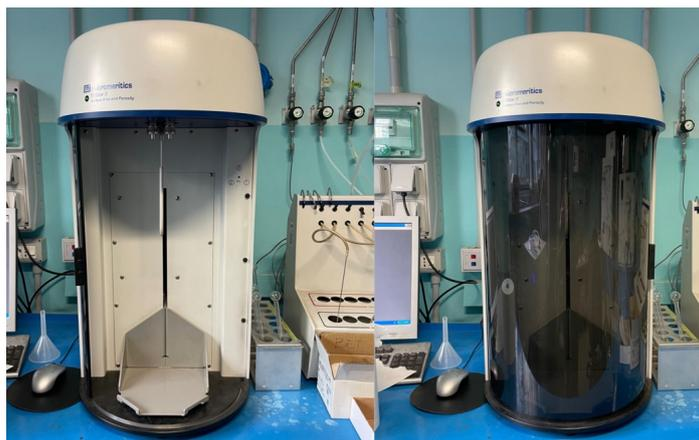
Figura 13 Apparechiatura utilizzata per BET
