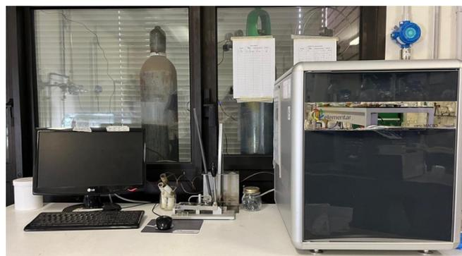
Figura 11 Immagine della postazione analizzatore elementare
