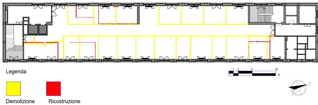
Figura 67: Indicazione Demolizioni e Ricostruzioni progetto
