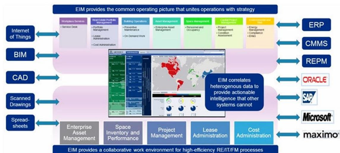
Figura 80: EIM creato all'interno di Archibus e bidirezionalità con i programmi e i modelli
